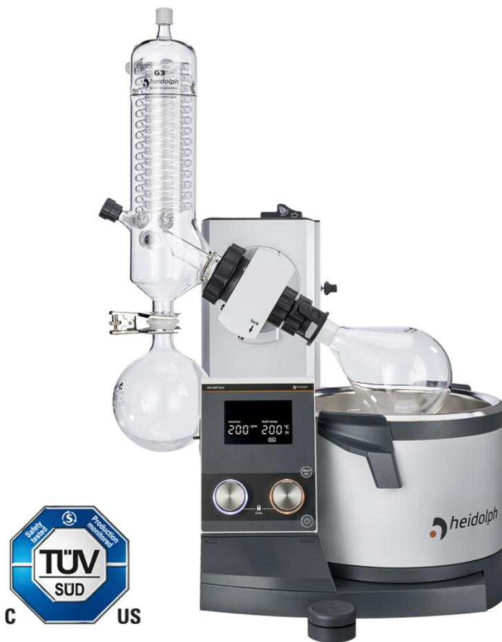
Ein auf das Wesentliche reduziertes Bedienkonzept: übersichtlich und jederzeit mit direktem Zugriff auf die Grundparameter Rotationsgeschwindigkeit und Heizbadtemperatur.
